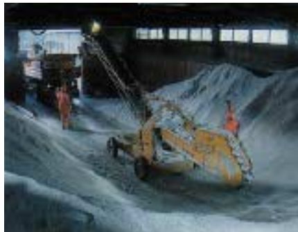
Beladen eines Winterdienstfahrzeuges mit dem Förderband
