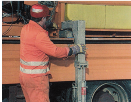
Entfernen der Stützen eines Streuautomaten
