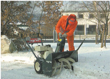
Einsatz des Stößels zum Beseitigen von Schneeverstopfungen
